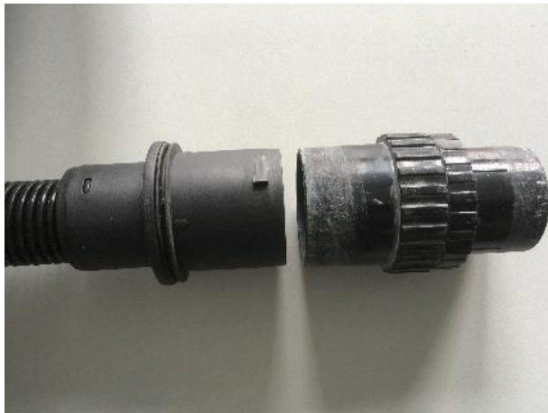
Bild 2: links: Anschlussmuffe Kärcher alt mit Rastnase, rechts: Anschlussmuffe für Entstauber mit 57/58 mm Konus. [Walter Gunreben - BG BAU]
